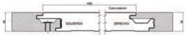
DETALLE ENTREGA POLICARBONATO - PANEL FACHADA - FIJACIÓN OCULTA
