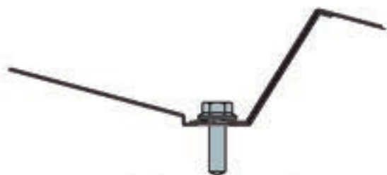
Detalle de solape y sujeción
